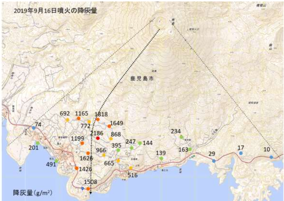
図 54 2019年9月16日7:46に始まったブルカノ式噴火とその後のストロンボリ式噴火によって放出された火山灰の降灰分布。太い破線は降灰の主軸方向。赤丸は2000g/m 2 以上、オレンジの丸は1000~2000g/m 2 、黄色は500~1000g/m 2 、緑色は100~500g/m 2 、青丸は100g/m 2 、未満の降灰観測点を示す。現地におけるサンプリング調査による。
